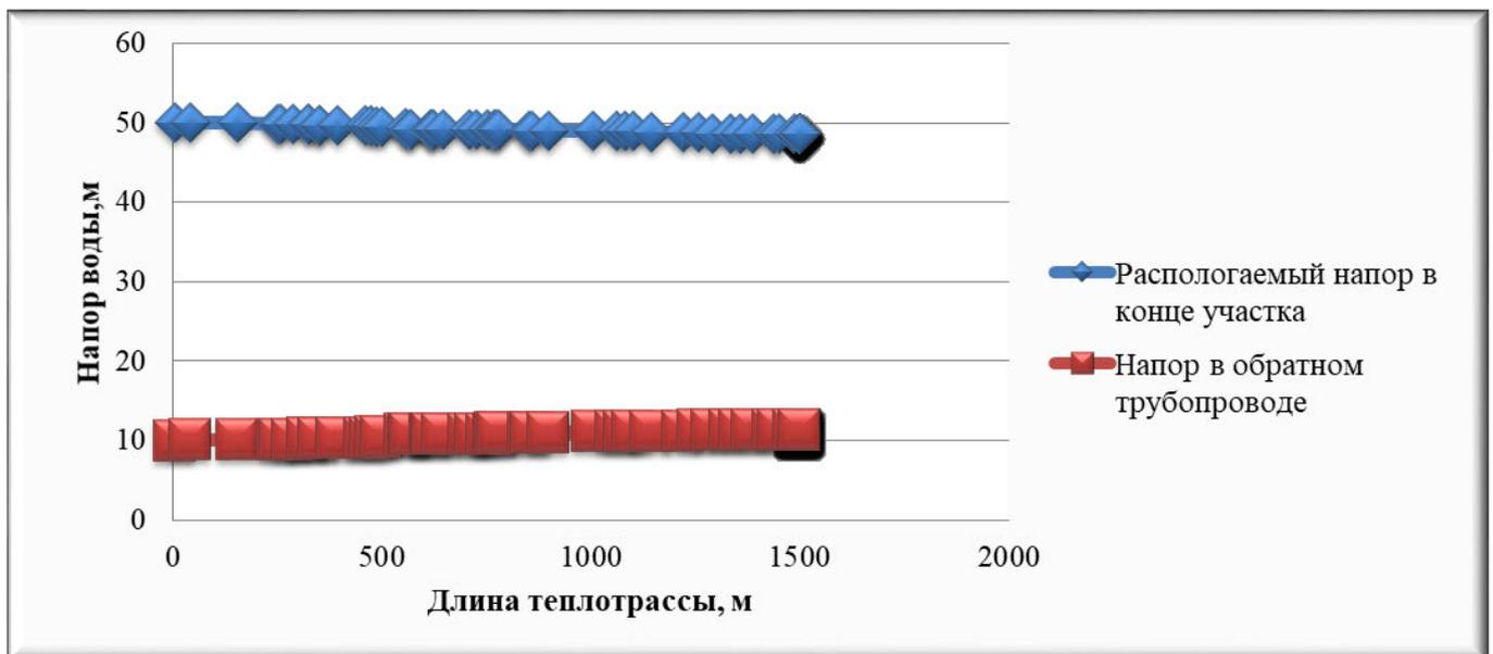
Рисунок 2.7 – Пьезометрический график тепловой сети котельной «Поселковая» с. Ново-Кусково по магистральному выводу
