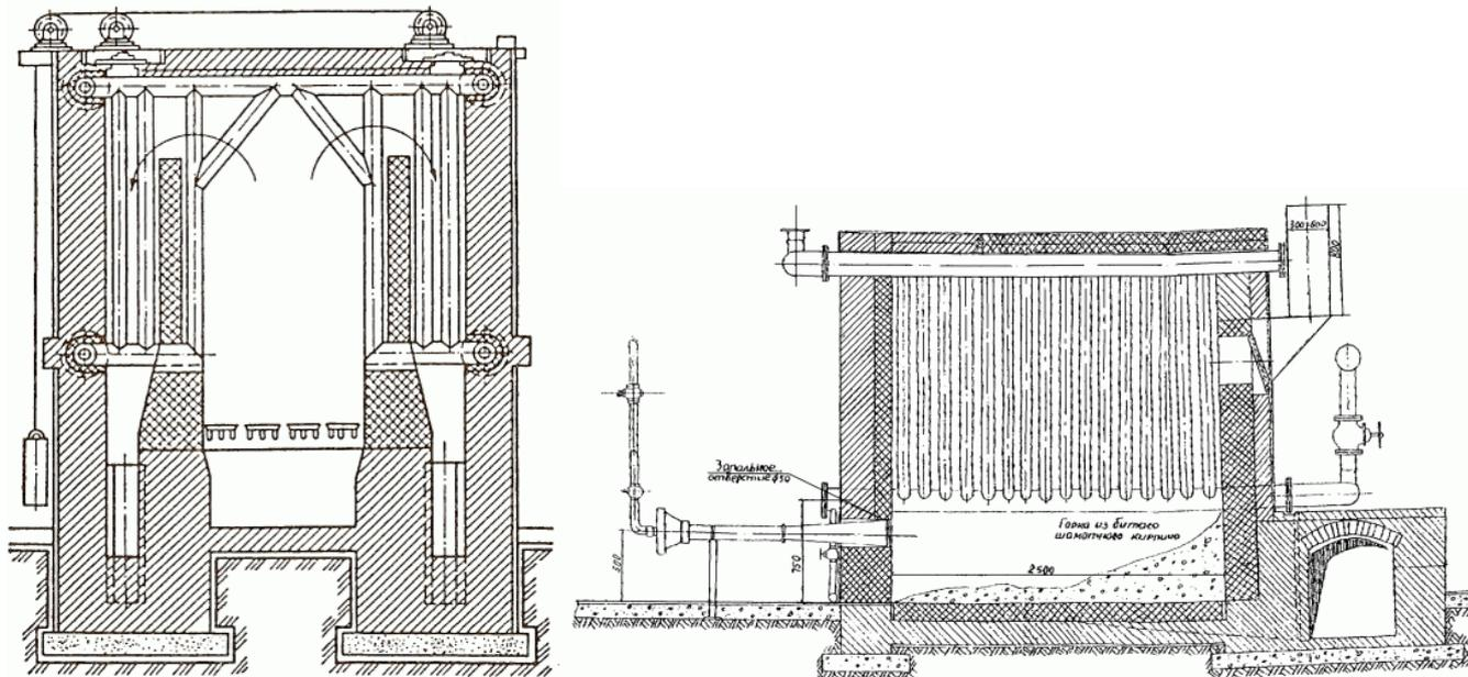
Рисунок 2.2 – Поперечный и продольный разрез котла НР-18
