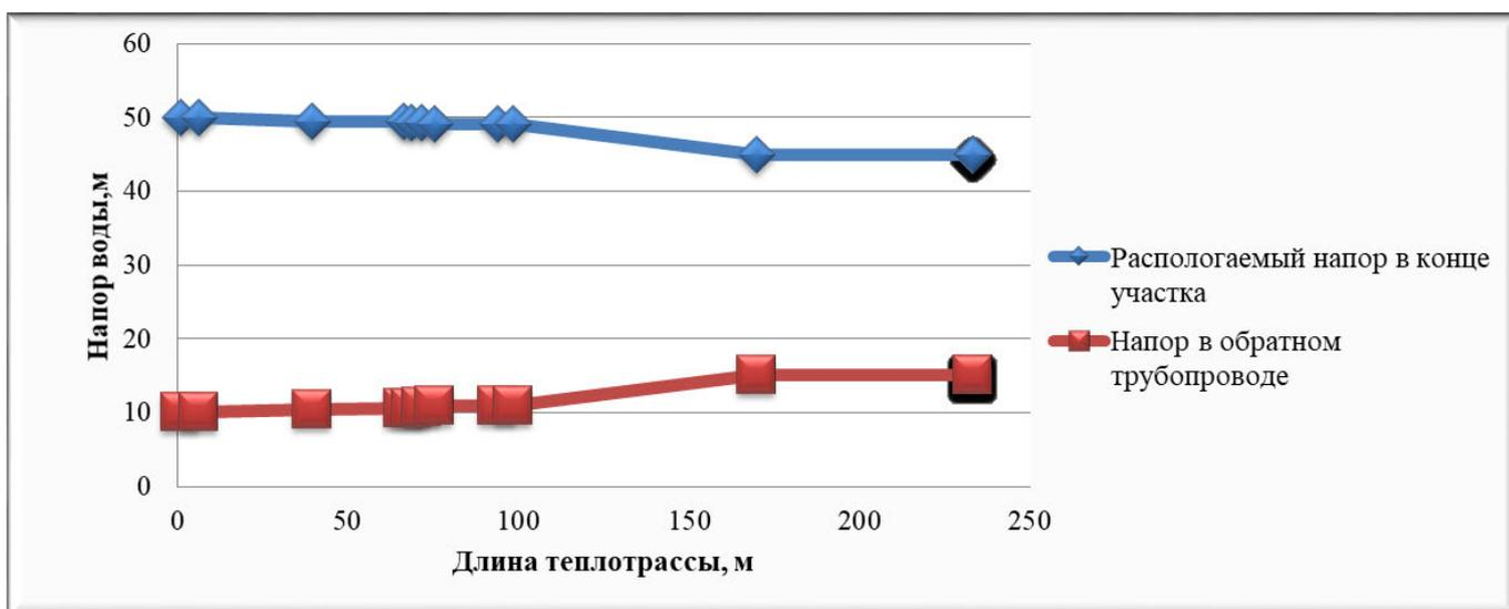
Рисунок 2.6 – Пьезометрический график тепловой сети котельной «Школьная» с. Ново-Кусково по магистральному выводу
