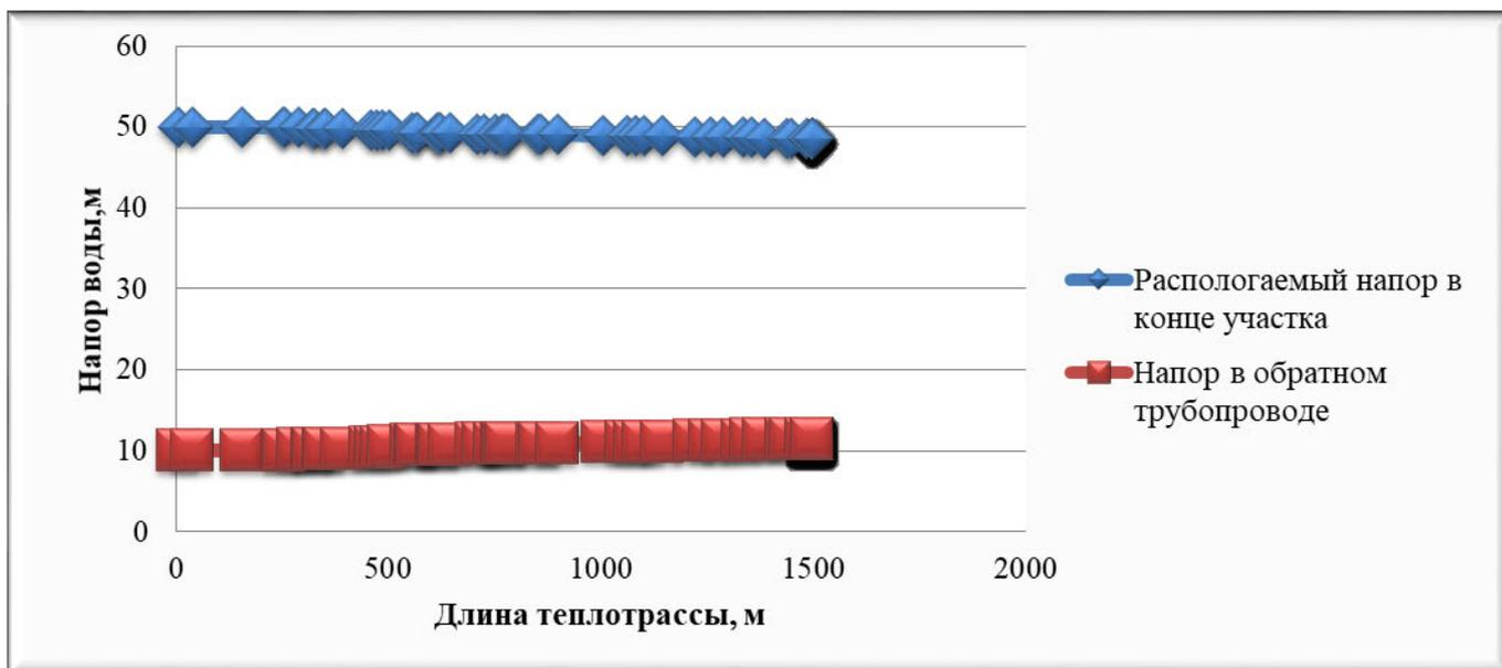
Рисунок 2.5 – Пьезометрический график тепловой сети котельной «Поселковая» с. Ново-Кусково по магистральному выводу
